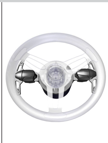
CONFIGURATION DU DISPOSITIF DE COMMANDE DOUBLE AVEC BASCULEMENT
