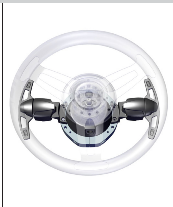
CONFIGURATION DU DISPOSITIF DE COMMANDE DOUBLE AVEC POMPE HYDRAULIQUE FRONTALE
